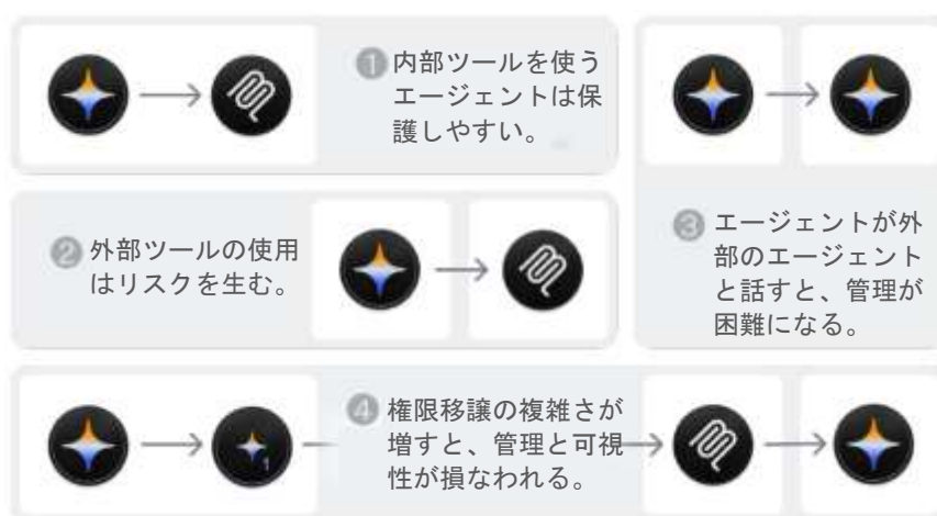
図2：トラストドメイン内（例：単一エンタープライズ）および信頼境界を越えたエージェント-ツール間通信（MCP）とエージェント間通信（A2A）のタイプ。外部通信と委任の増加に伴い、複雑性、セキュリティリスク、可観測性、アイデンティティ課題はすべて困難になる。
